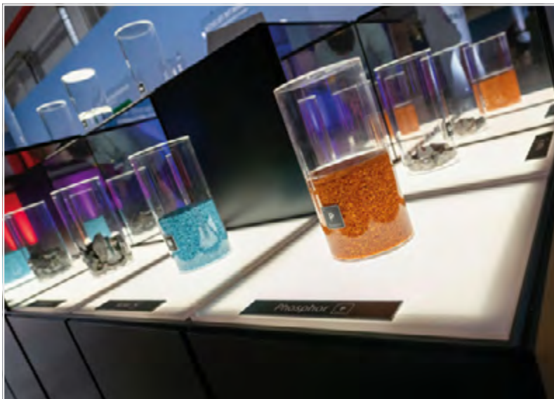
Werthaltige Sekundär-Rohstoffe aus Batterien. Das Foto zeigt Proben von recyceltem Phosphor (orange Granulate), Nickel (schwarzes Pulver) – substantial-times.com
