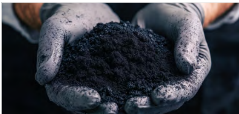
Schwarzmasse aus der mechanischen Vorbehandlung ausgedienter Batterien (Symbolfoto) – euwid-recycling.de
